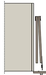
**Exedra2 Smart** est la version qui nécessite une profondeur inférieure du meuble ; le bord des portes sont visibles lorsqu'elles sont repliées dans leur compartiment.
