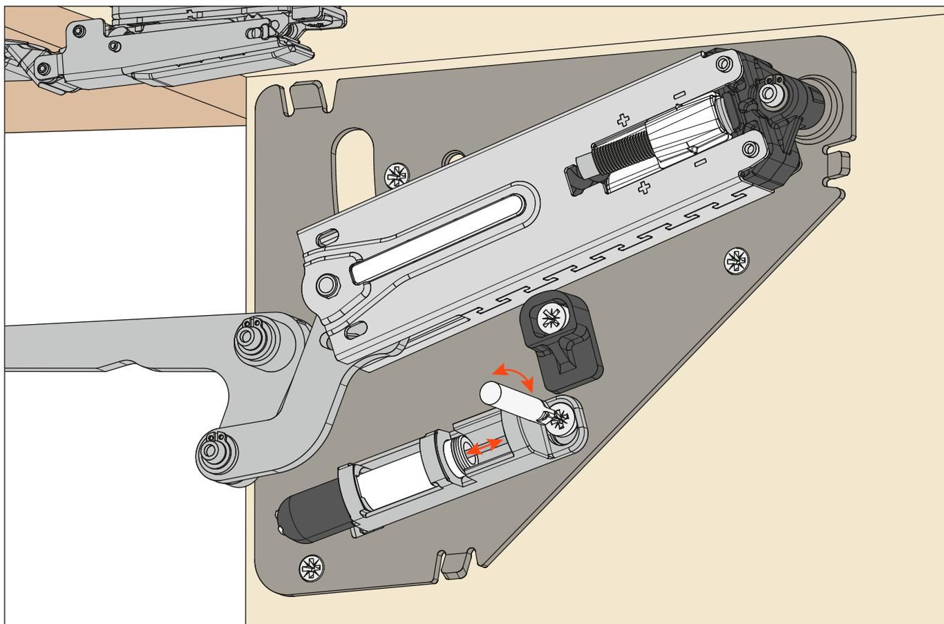
**Regulación del ángulo de apertura de la puerta, mediante excéntrico, de 80° a 92°.**
