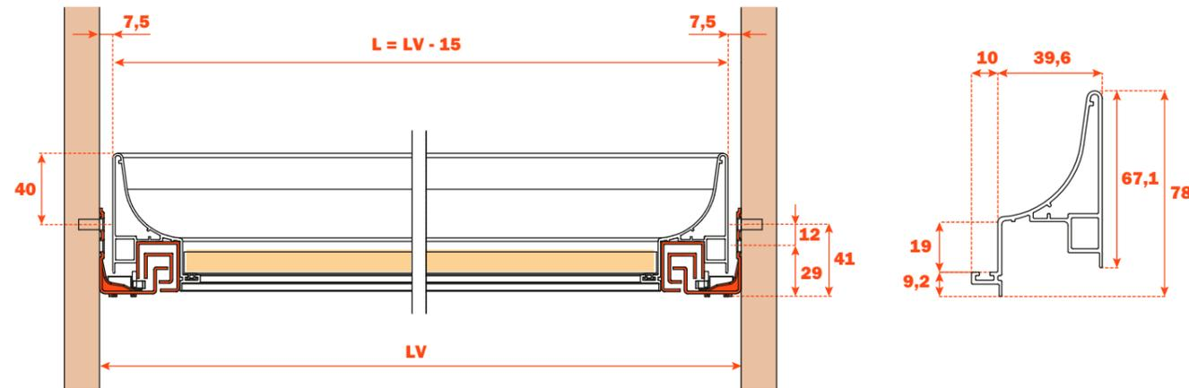
**MONTAGEM COM FRENTE MADEIRA, ESPESSURA 12 mm**
