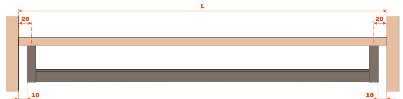
Suporte central do tubo necessário para tubos com comprimento acima de 1200 mm ou cargas superiores a 15 Kg
