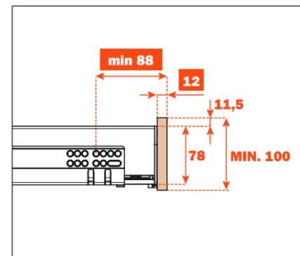
**MONTAGEM COM FRENTE MADEIRA, ESPESSURA 19 mm**
