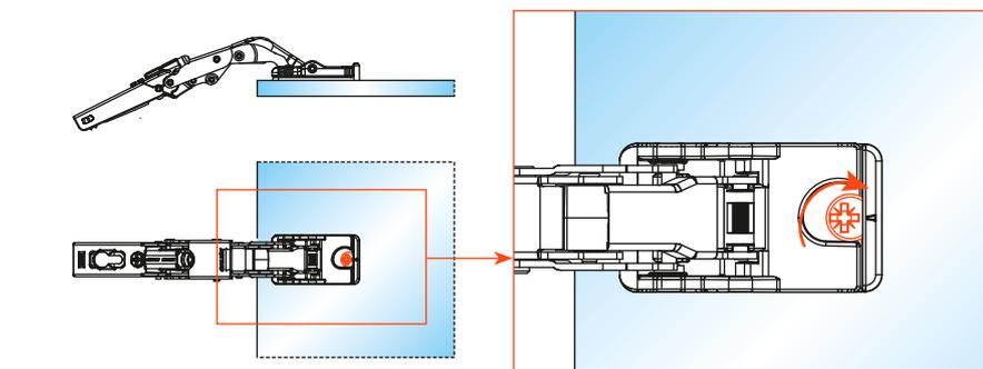
**3)** Tourner la vis excentrique de fixation.
