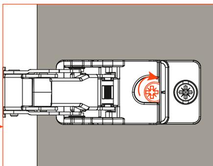
**3) Rotate the locking cam.**
