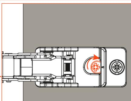
**3) Tourner la vis excentrique de fixation.**
