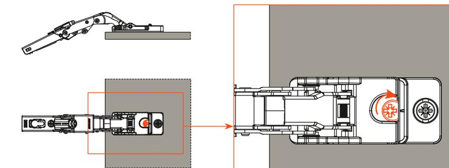
**3)** Ruotare l'eccentrico di fissaggio.
