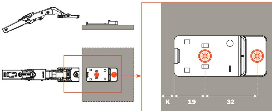
**1)** Fissare la piastra all'anta con le viti fornite.
