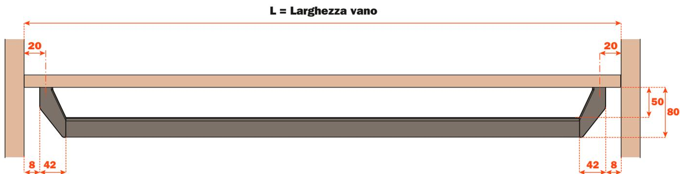
Supporto reggitubo centrale necessario per tubi con lunghezza maggiore di 1200 mm o carichi superiori a 15 Kg
