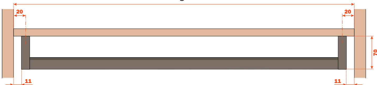
Supporto reggitubo centrale necessario per tubi con lunghezza maggiore di 1200 mm o carichi superiori a 15 Kg
