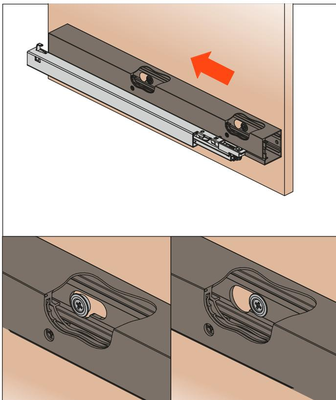
6. Bloccare il distanziale con la vite di fissaggio anteriore
