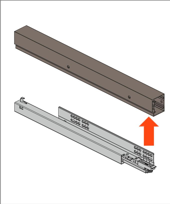
2. Die Führung am Distanzstück mit den gelieferten Schrauben befestigen
