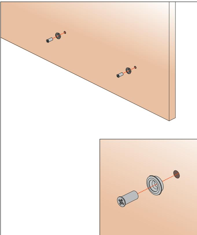
4. Die Führung auf den Träger einsetzen
