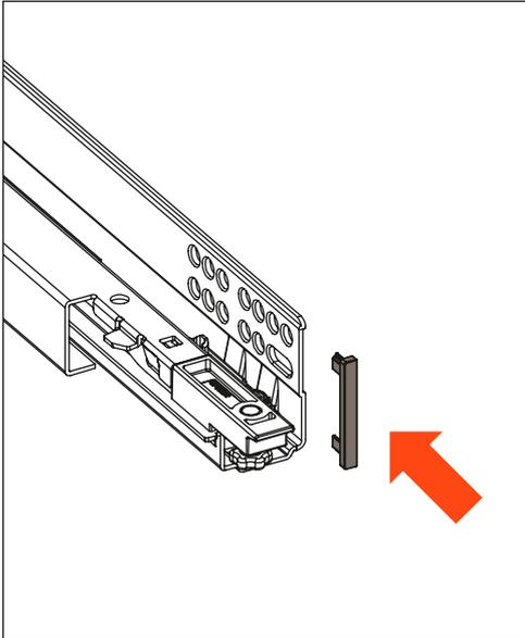
2. Den Abdeckgehäuse auf die Führung befestigen
