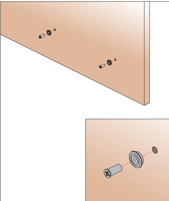
4. Die Führung auf den Träger einsetzen
