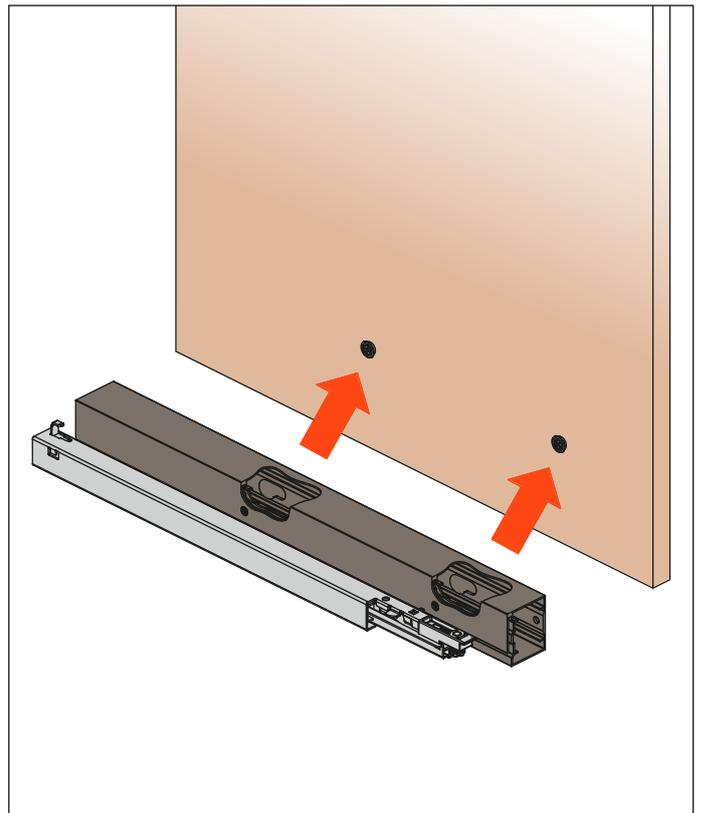
5. Die Führung rückwärts schieben lassen, um sie an den Träger zu blockieren
