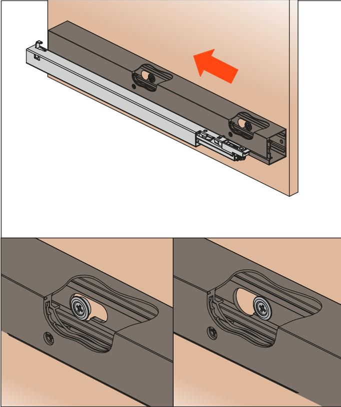
6. Das Distanzstück mit der vorderen Befestigungsschraube blockieren
