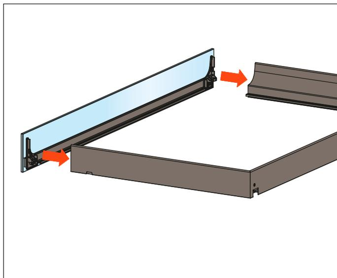
5. Insérer les attaches dans les deux côtés
