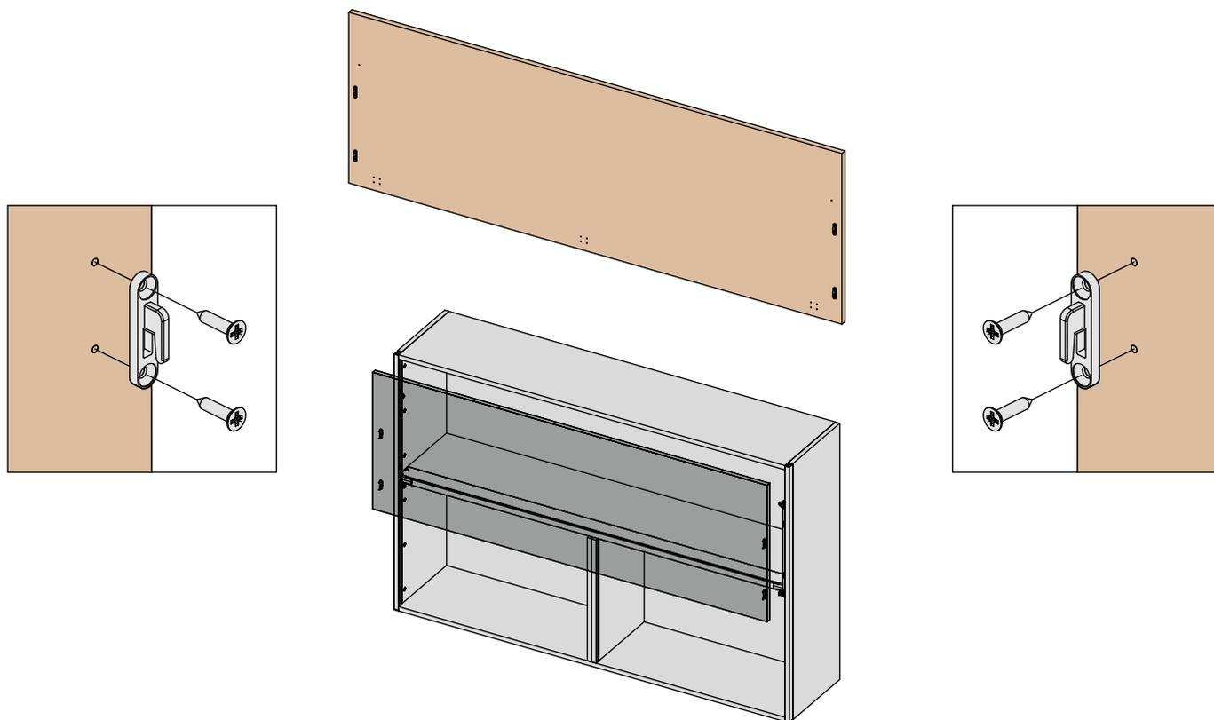
Com muito cuidado deslize a porta para baixo até permitir o bloqueio definitivo da porta ao suporte de fixação com os parafusos fornecidos com a ferragem.
