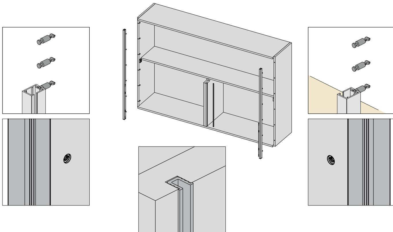
Inserir o perfil base nos suportes laterais já aplicados na lateral e fixá-los com os parafusos fornecidos.
