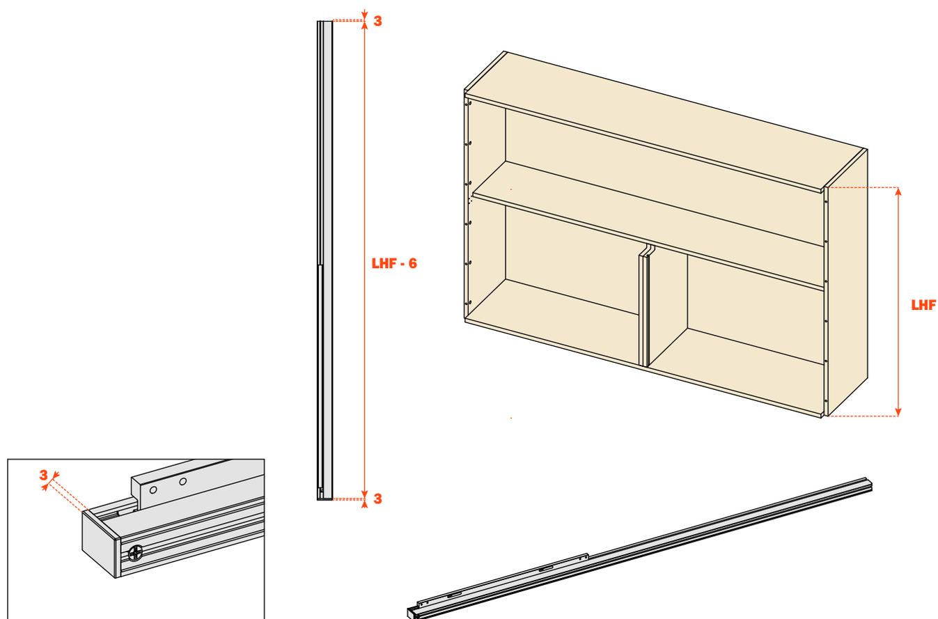
Insertar los pernos de unión en las guías laterales y aplicarlas a los paneles laterales mediante los tornillos excéntricos mecanizados anteriormente.
