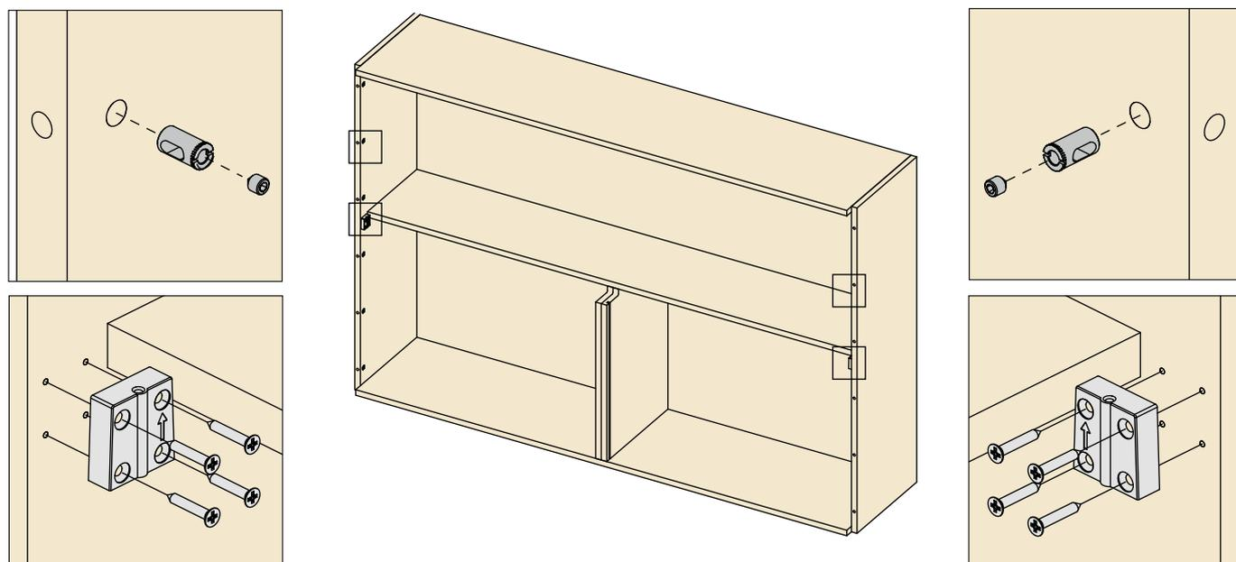
Fijar los soportes para el perfil horizontal base sobre la cara interna del panel lateral e insertar los tornillos excéntricos suministrados en el blister de accesorios.
