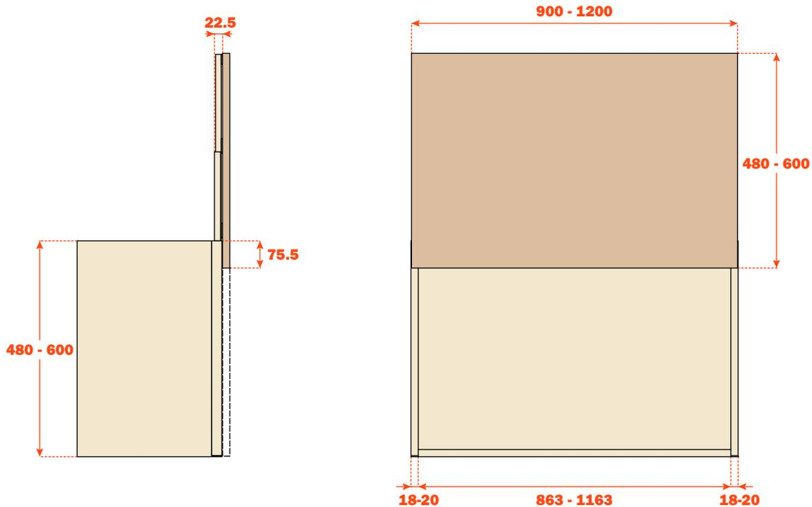
Sistema de 1800 mm e 2400 mm requer uma terceira guia e uma usinagem na divisória central; altura de 480 mm e 600 mm.
