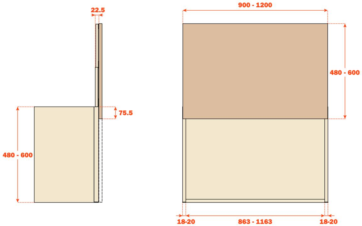
System von 1800 mm und 2400 mm. Diese Version erfordert eine dritte Schiene und ein Fräsen für die mittlere Seite. Höhe 480 mm und 600 mm.
