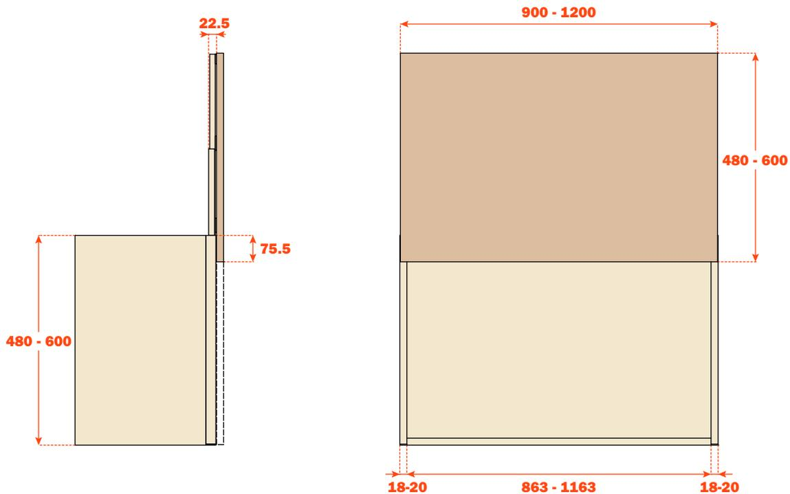
Sistema da 1800 mm e 2400 mm necessita di una terza guida e una lavorazione di scarico sulla spalla centrale; altezza 480 mm e 600 mm.
