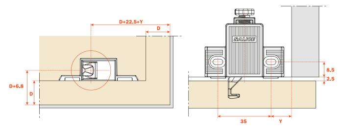
= Copertura dell'anta sul fianco e sul cappello del mobile.
