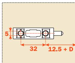
Adaptador longitudinal inclinado de zamak.
