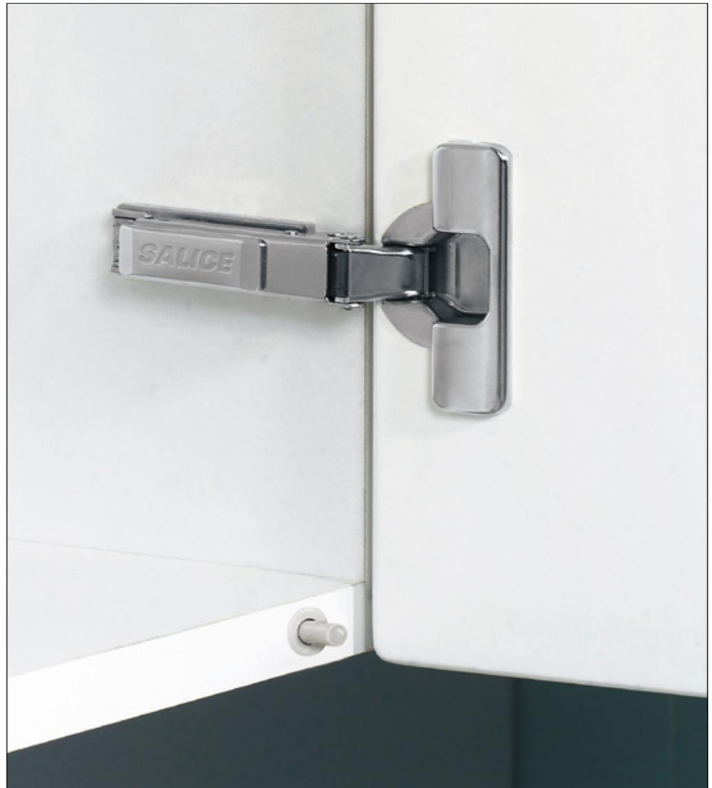
Eine Bohrung in der optimalen Position für den erworbenen Smove mit 10 mm  $\varnothing$  und mindestens 50 mm Tiefe durchführen, den Smove dann in die Bohrung einsetzen.
