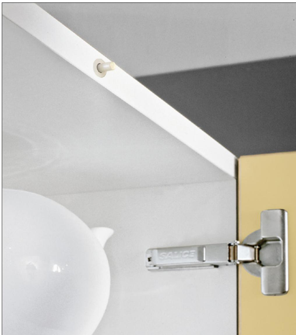
Eine Bohrung in der optimalen Position für den erworbenen Smove mit 10 mm Ø und mindestens 50 mm Tiefe durchführen, den Smove dann in die Bohrung einsetzen.
