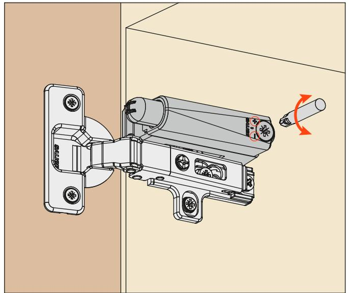
Para el desmontaje, con un destornillador sopalancar en la ranura indicada.
