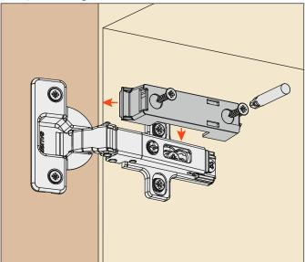
Den Smovehalter einsetzen und ihn bis zum Einrasten in Pfeilrichtung schieben.
