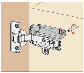
Für die Demontage, einen Schraubenzieher in den angegebenen Schlitz einsetzen und darauf einwirken.
