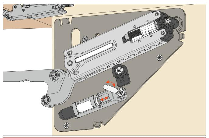
Regolazione dell'angolo di apertura dell'anta, tramite eccentrico, da 80° a 92°.
