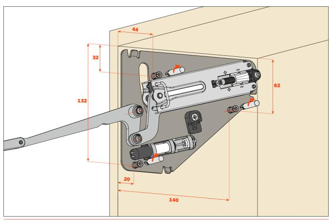
Montaggio dell'anta sul mobile.
