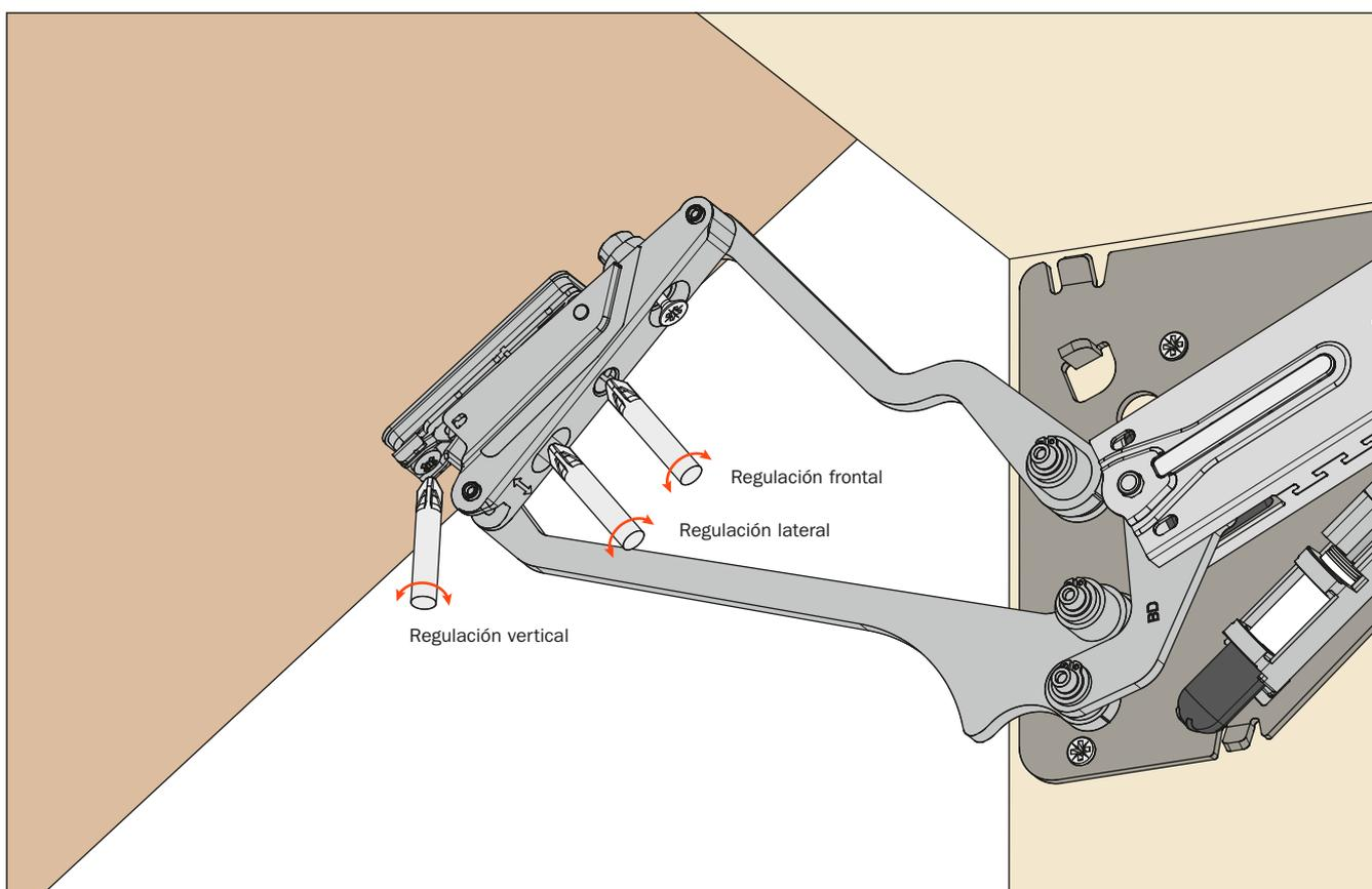
**EvoLift - Sistemas de alzamiento - Sistema de abertura puerta basculante****Instrucciones de montaje****Efectuar la fijación suplementaria después de las regulaciones.**
