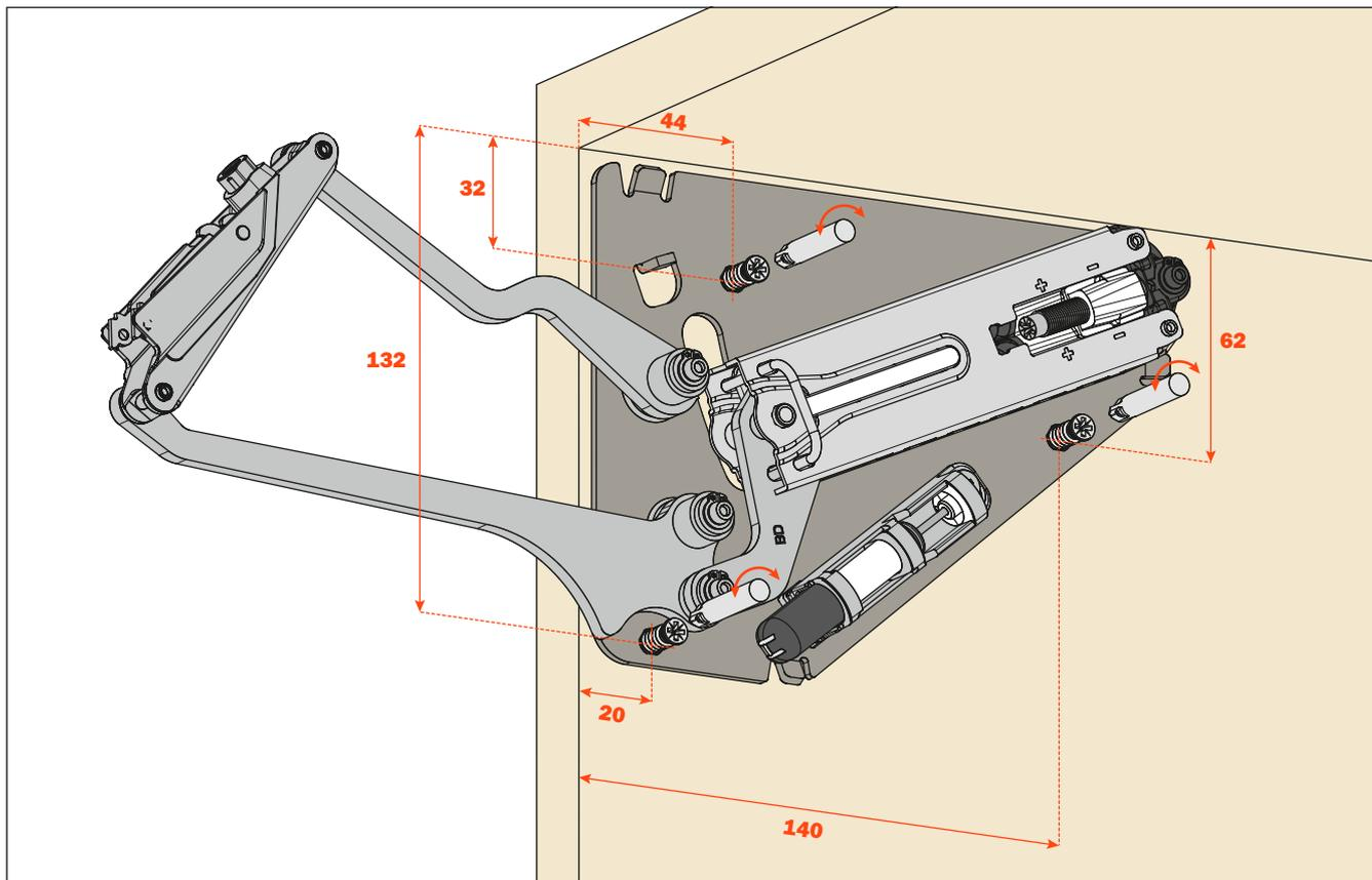
**Montaggio dell'anta sul mobile.**
