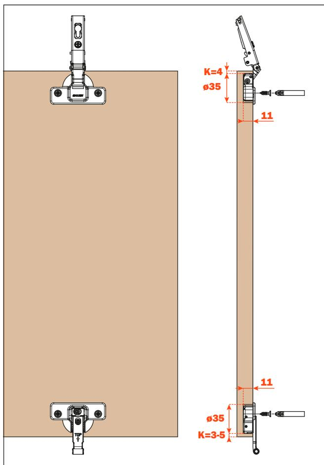
**Perçage de la porte supérieure avec profilé en aluminium largeur min. 45 mm.**
