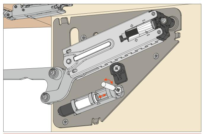
Réglage de l'angle d'ouverture de la porte, par vis excentrique, de 80° à 92°.
