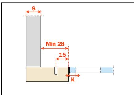
Contrecoudé utilisable uniquement avec les embases de la Série 200 pour les montages traditionnels avec perçage 28x32 mm.
