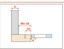
**Controcollo** utilizzabile solo con le basi Serie 200 per montaggi tradizionali, foratura 28x32 mm.
