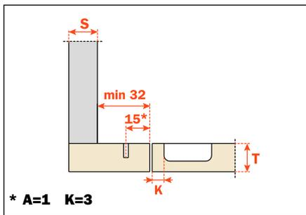
**Lisenenscharniere.** Passend für Montageplatten Serie 200 mit Bohrung 28x32 mm.
