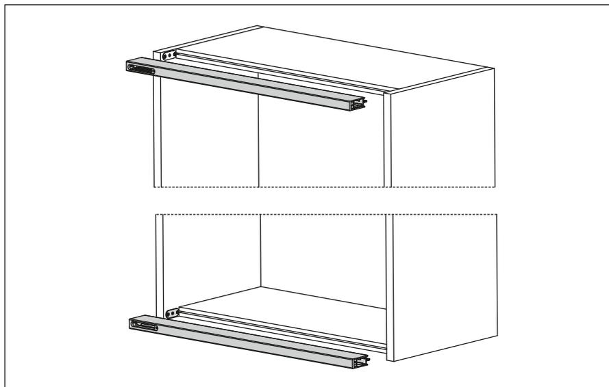
Insira o perfil nas placas e no canal do móvel. Recomendamos utilizar uma cola de poliuretano monocomponente e de baixa expansão, adequada para colagem de madeira e metal.
