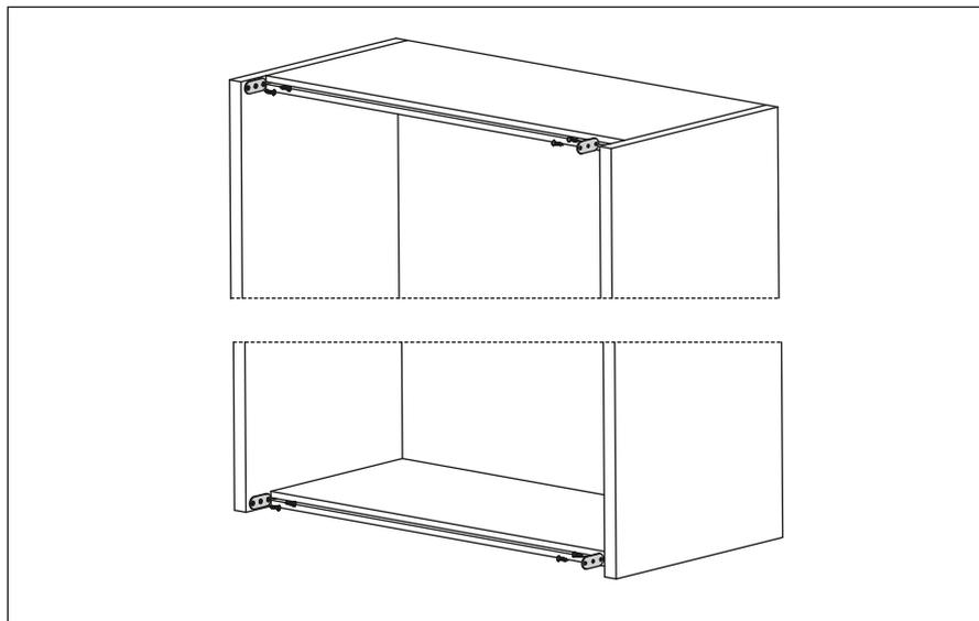
Dopo aver fresato il cappello e la base del mobile applicare le placchette di sostegno del profilo.
