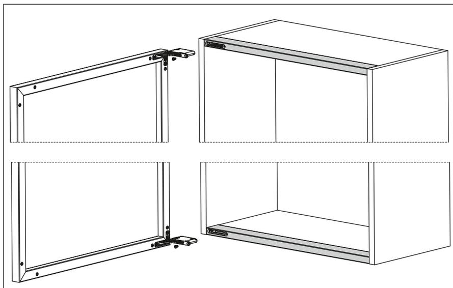
Ad installazione avvenuta inserire e fissare le cerniere nel profilo.
