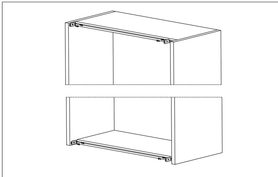
Une fois les panneaux supérieur et inférieur du meuble fraisés, procédez à la pose des plaques de support pour le profilé.
