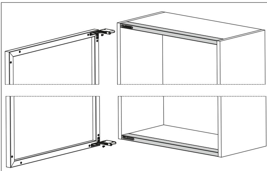
Nach der Montage können die Scharniere in das Profil eingesetzt und fixiert werden.
