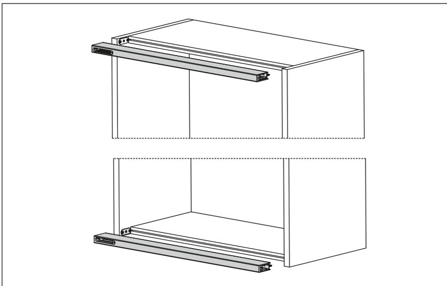
Schieben Sie das Profil auf die Befestigungsplatten und in die Möbelnut. Wir empfehlen die Verwendung eines Einkomponenten-Polyurethan-Klebers mit geringer Ausdehnung, der zum Verkleben von Holz und Metall geeignet ist.
