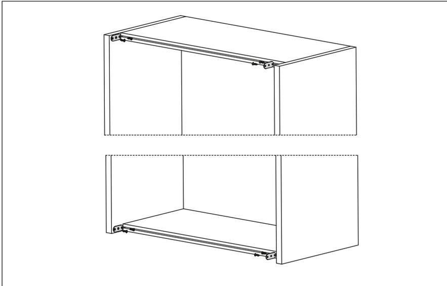
Nachdem Sie den Ober- und Unterboden des Möbels gefräst haben, bringen Sie die Befestigungsplatten für das Profil an.
