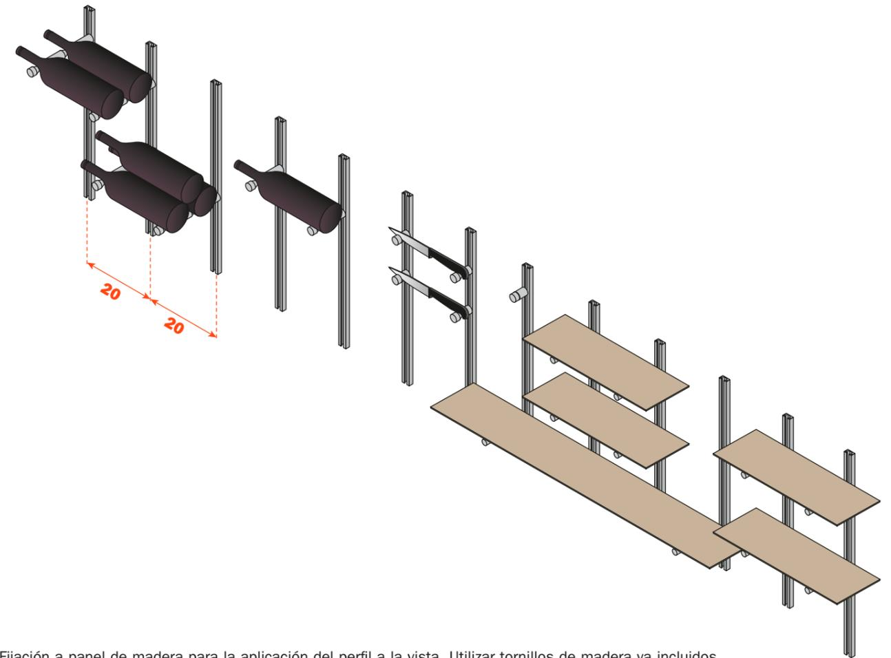
Fijación a panel de madera para la aplicación del perfil a la vista. Utilizar tornillos de madera ya incluidos.
