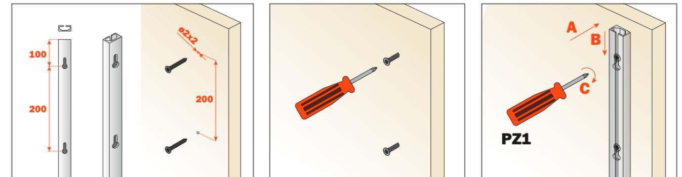
Fijación a pared para la aplicación del perfil a la vista. Utilizar tornillos de tacos ya incluidos.
