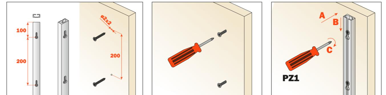
Bohrung der Wand für die Befestigung des frei montierten Profils. Verwenden Sie die mitgelieferten Schrauben mit Dübeln.
