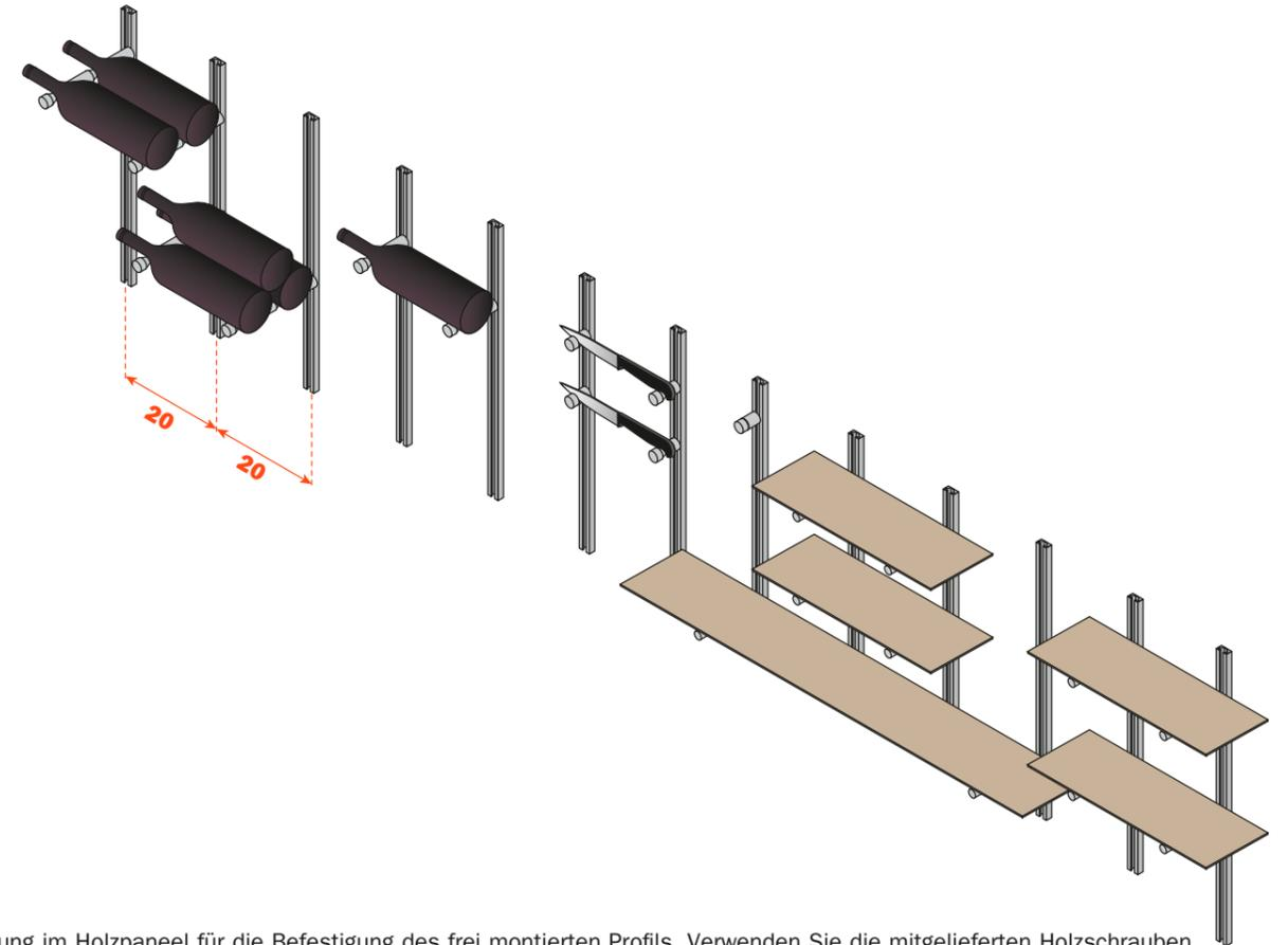
Bohrung im Holzpaneel für die Befestigung des frei montierten Profils. Verwenden Sie die mitgelieferten Holzschrauben.
