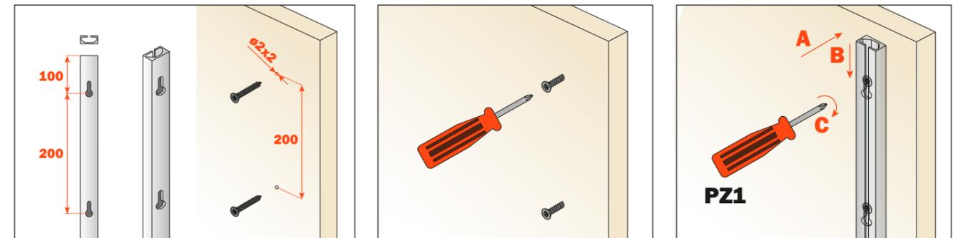
Foratura del muro per applicazione del profilo a vista. Utilizzare viti con tasselli già fornite.
