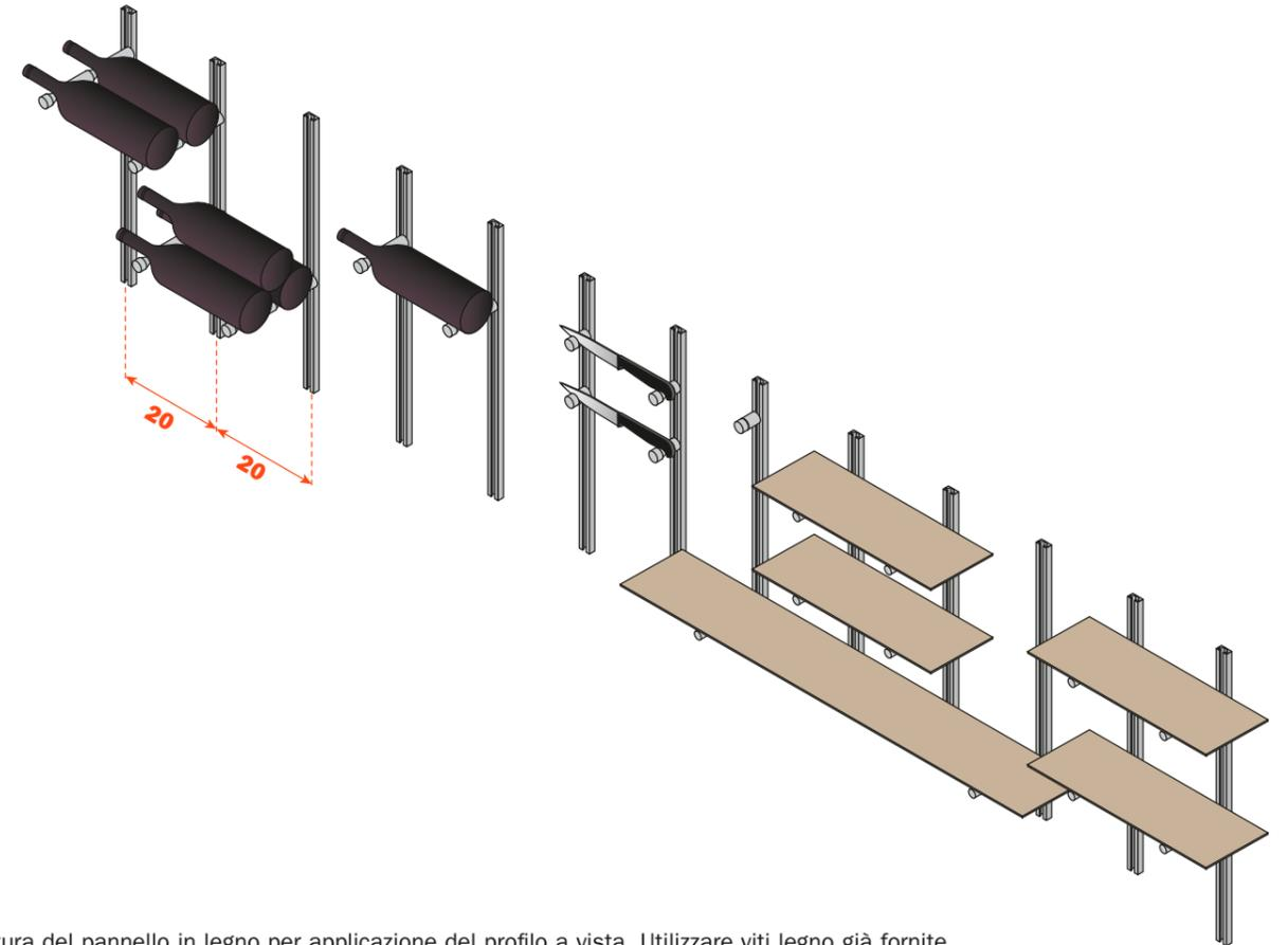
Foratura del pannello in legno per applicazione del profilo a vista. Utilizzare viti legno già fornite.
