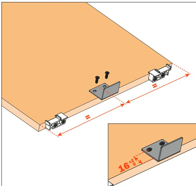
2) Fijación del imán sobre el panel inferior fijo del mueble.
