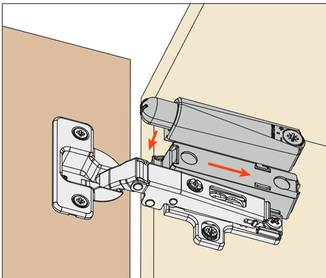
Durch die hintere Verstellerschraube lässt sich der Dämpfungseffekt erhöhen oder reduzieren.
