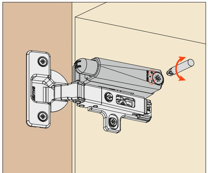
Für die Demontage, einen Schraubenzieher in den angegebenen Schlitz einsetzen und darauf einwirken.
