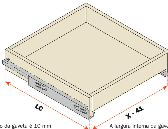
O comprimento da gaveta é 10 mm menor do que o comprimento da corrediça
