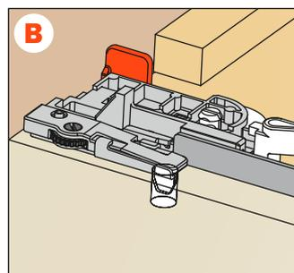
Dispositivo anti-deslocamento para cima - fixação sobre gaveta
