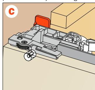
Dispositivo anti-deslocamento para cima - fixação sobre frontal
