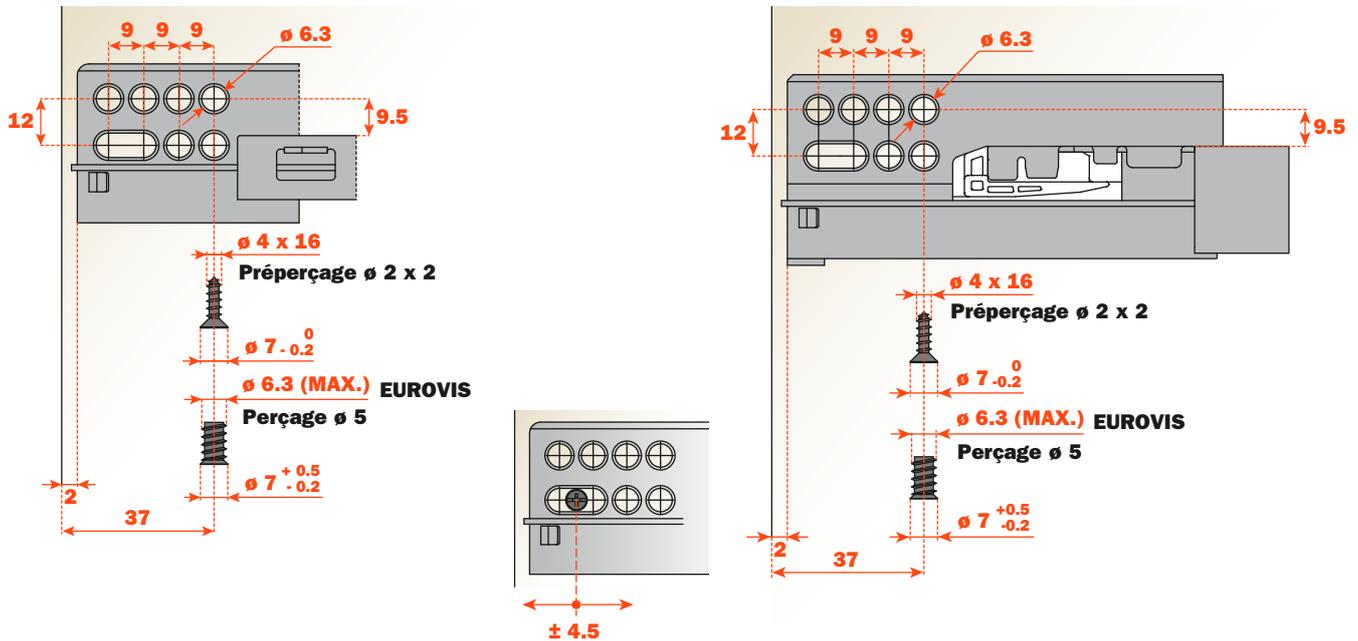
Le trou ovale permet le réglage profondeur du tiroir. Grâce à ce trou, on peut aligner les façades des meubles à tiroirs avec tiroirs rentrants ou avec coulisses avec ouverture Push.
