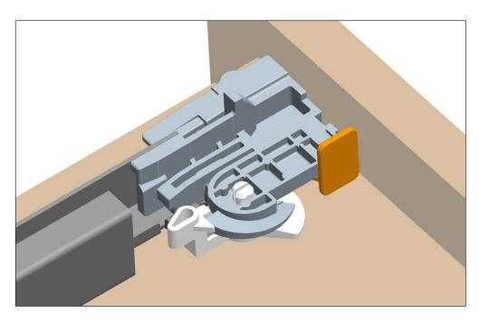
Den Hebel in Richtung Frontblende der Schublade drehen, um die Höhenverstellung zu erreichen.
