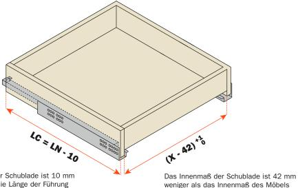
Die Länge der Schublade ist 10 mm weniger als die Länge der Führung
