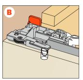
Antikippsicherung -Befestigung auf der Schublade
