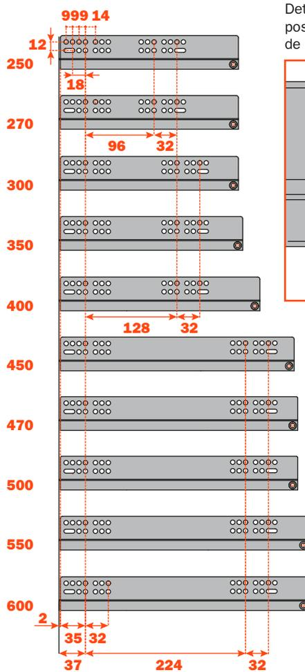
Detalhe do furo posterior suplementar de fixação
