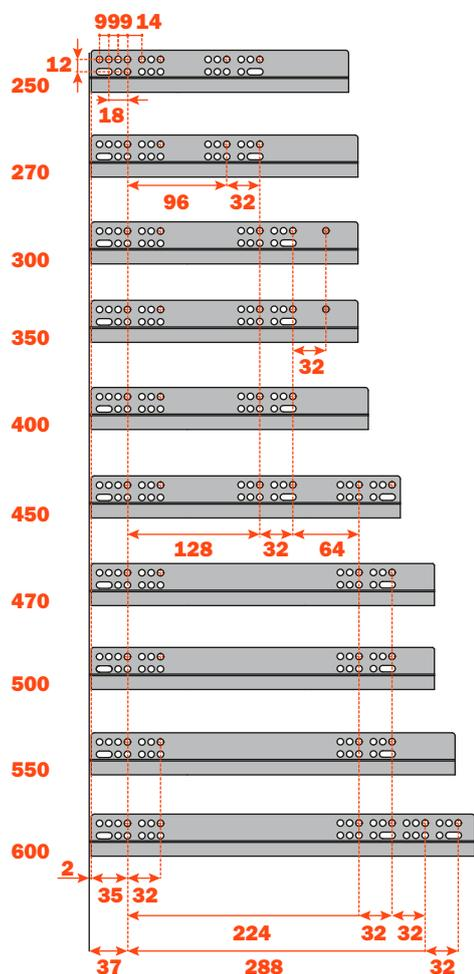
**Posizione fori di fissaggio guida sul fianco del mobile. Estrazione totale**
