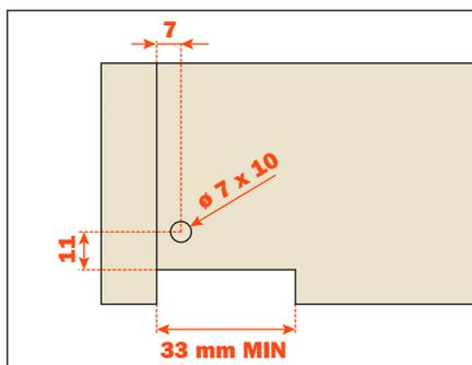
**SCARICO POSTERIORE con sincronizzatore per guide Futura Push**
