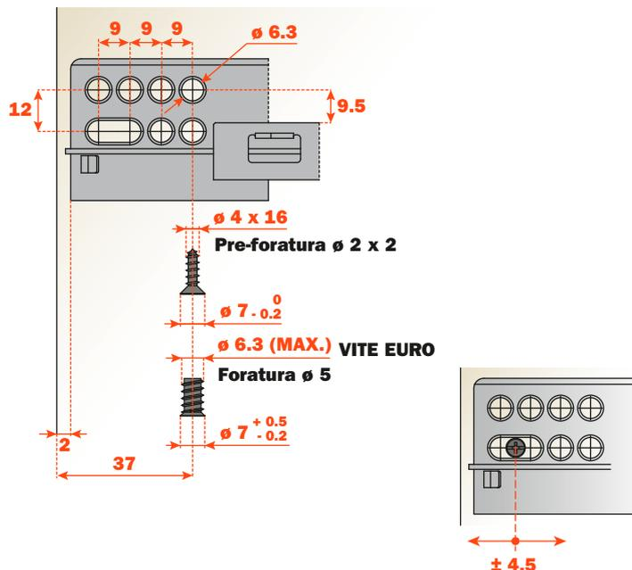
**Fissaggio della guida a estrazione totale sul fianco del mobile.**
