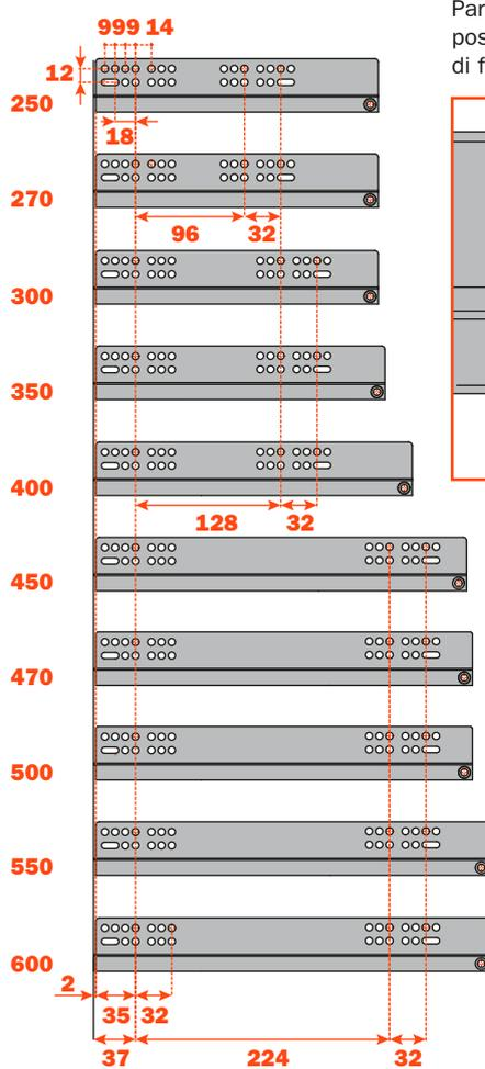
Particolare del foro posteriore supplementare di fissaggio
