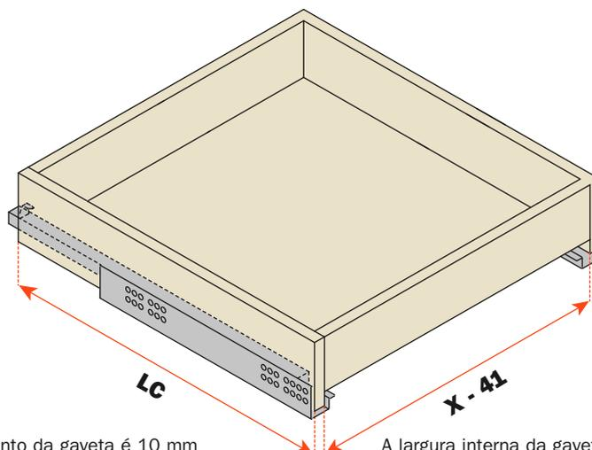
O comprimento da gaveta é 10 mm menor que o comprimento da guia
