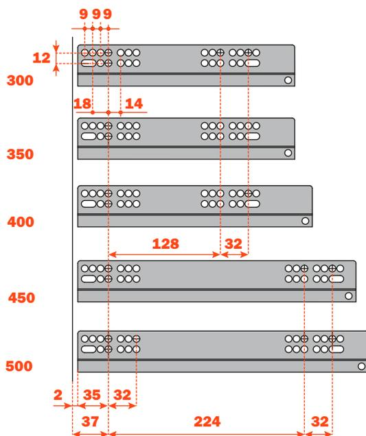
Para a função Push necessita-se de um valor de  $A = 2,5$  mm. Este valor é obtido posicionando-se a corrediça a 37 mm da lateral da borda do móvel.
