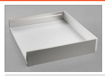
Laterais metálicas Lineabox, frontal e traseira em madeira. Altura da lateral 104 mm - Altura interna 72 mm. Para todas as corrediças Futura extração total: 655 - 6557 - 6555 (Ver catálogo geral "Corrediças e gavetas").
