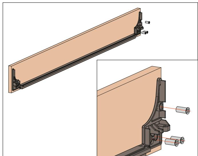
5. Insérer les attaches dans les deux côtés
