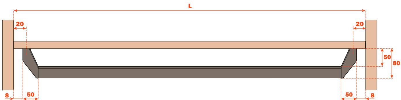
Support central nécessaire pour barres de longueur supérieure à 1200 mm ou charges supérieures à 15 Kg
