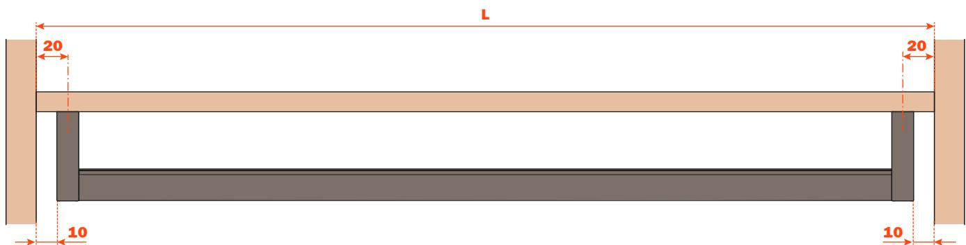
Support central nécessaire pour barres de longueur supérieure à 1200 mm ou charges supérieures à 15 Kg
