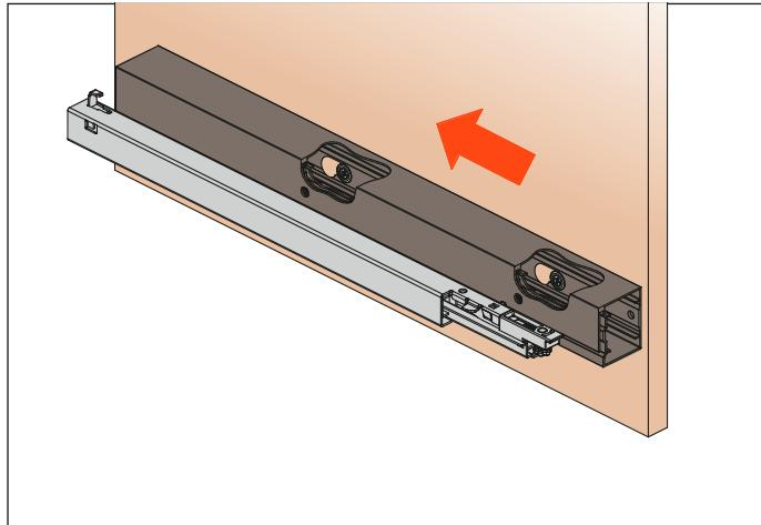
6. Fixer la calle d'épaisseur avec la vis de fixation avant
