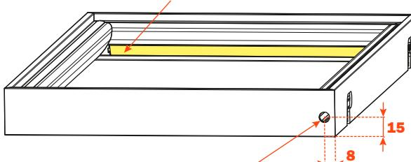
Perçage de sortie du câble électrique
